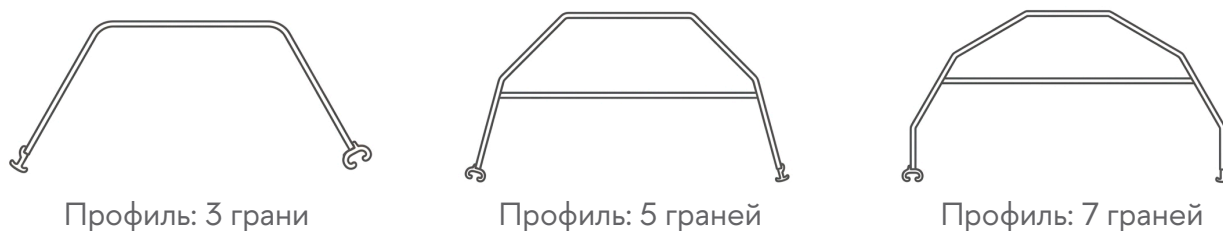
Рис. 4. Профили холодногнутых многогранных шпунтов Grani / Grani Pro
